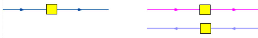
Рис. 3.14. Изображение тепловой камеры во внешнем (слева) и внутреннем (справа) представлении
